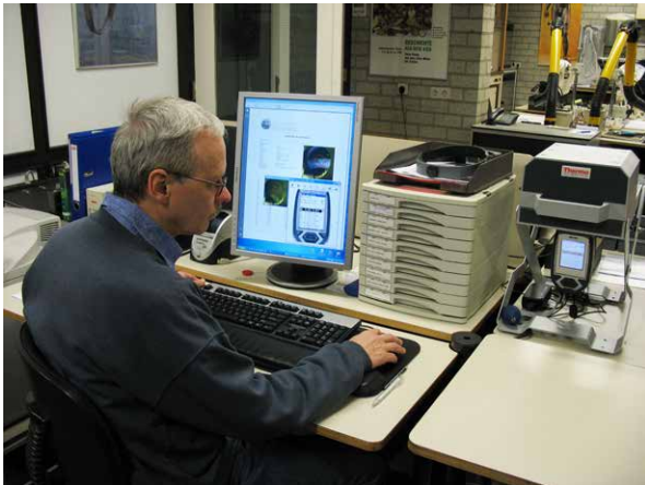
Fig. 11.15 Het uitvoeren van analyses met de XRF. Het te analyseren object bevindt zich in een loden cabine, rechts op de afbeelding (Restaura).
