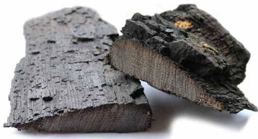
Fig. 6.4 Doorsnede van een recent aangekoolde eikenhouten balk. Door het vuur op een bepaald moment te stoppen bleef de interne structuur van het hout onaantast. Dat deel is vergaet in de loop van de tijd, de verkolde randen blijven bewaard (R. Jansen/FdA, UL).
